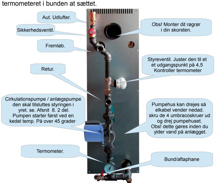
Kontroller at alle samlinger er spændt efter, påfyld nu vand på anlægget via bundhane på sættet og luft anlægget ud.
