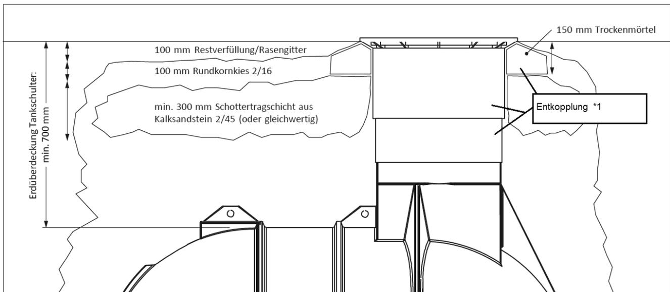
**Abbildung 5: Bauseitige Herstellung eines befahrbaren Überbaus mit Teleskopdom**
